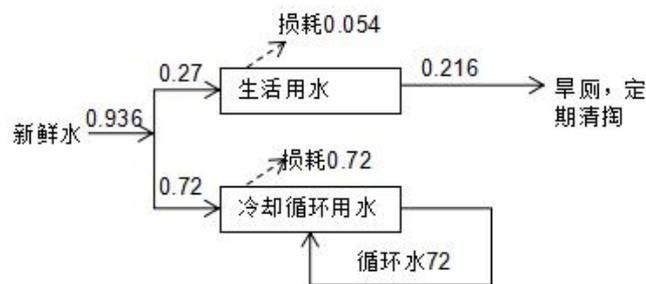
图 2-1 本项目水平衡图 单位：m<sup>3</sup>/d
